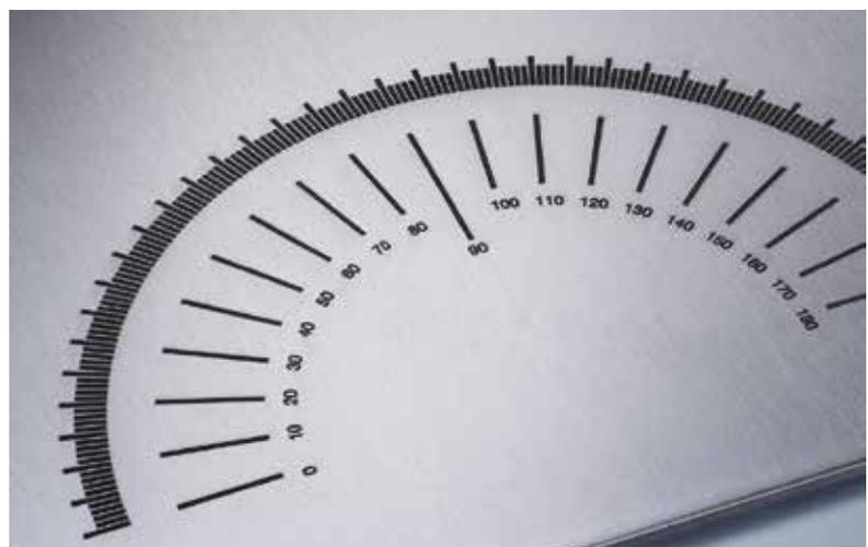
Zu den erweiterten auswählbaren Technologien gehören das präzise und hochauflösende Laserbeschriften zur Teilekennzeichnung wie Identifikationscodes, Seriennummern oder Logos (Bilder: © H.P. Kaysser)
